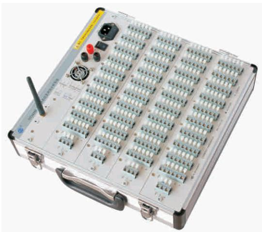
TST3826EW无线静态应变测试分析系统每台采集箱40测点，同一台计算机可控32台采集箱同时工作。采用德国进口WAGO压线端子，接线更加方便，程控切换桥路。采用FSK无线载波技术，保证了数据传送的高速、稳定、不漏码，视距情况下无线传输距离可达300m。可与热电偶或铂电阻配合，通过分度号的计算，对温度进行多点巡回检测；高速ARM处理器，配合自主研发的软硬件信号处理技术，提高了系统的稳定性，大大增强现场抗干扰能力。以太网接口，即插即用，方便可靠。内置Q-FAN温度控制系统，进一步减少温度对测量结果的影响。适用于测量精度要求较高和现场复杂以及测点相对集中的场合，交直流供电。
