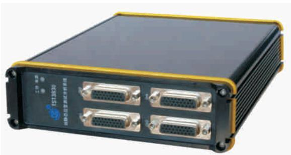
TST3830动静态应变测试分析系统适合测量缓慢变化的应变信号，采用智能化高速巡回数据采集系统，最高采样频100Hz，24位A/D转换器，可完成1 / 4桥（三线制）、半桥、全桥状态的静态应变（应力）的多点高速巡回检测。
