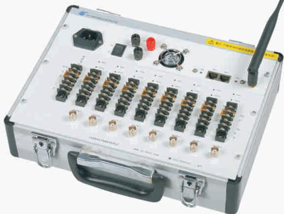
TST3829无线动静态信号测试分析系统采用Wi-Fi无线技术，可以与计算机无线网卡直接通讯，最高采样率达500Hz；综合了静态应变仪和动态应变仪的特点，适用于测量缓慢变化的物理量。内置高速ARM处理器，实时数字滤波，构成了模拟滤波和数字滤波的高性能抗混滤波器，测量精度更高，实时性更好。每通道独立A/D转换器，各通道信号同步采样、同步传输、实时显示、实时存盘。
