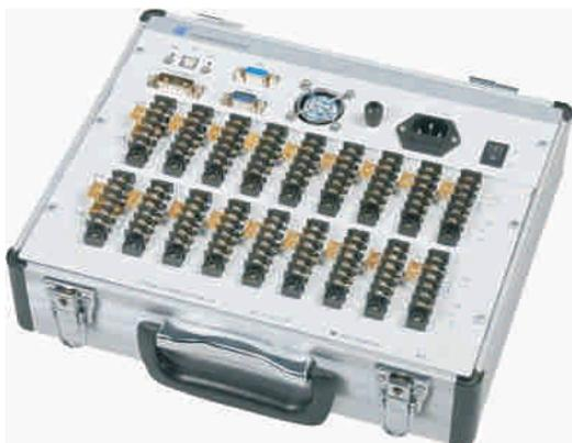
TST3825 静态应变测试分析系统是专门为野外测量量身定做的仪器，该系统的特点是所有采集箱由主机统一供电，解决了野外现场仪器供电难的问题。USB 接口，即插即用，方便可靠。同一台计算机可控制 256 台仪器同时工作，最高采样频率 2Hz，高速 ARM 处理器，配合自主研发的软硬件信号处理技术，提高了系统的稳定性，大大增强现场抗干扰能力。内置 Q-FAN 温度控制系统，进一步减少温度对测量结果的影响。该系统在国内率先采用 ARM 处理器和高性能 A/D 转换器，以及配合自主研发的软硬件信号处理技术，提高了系统的稳定性，使系统具有极强的现场抗干扰能力。
