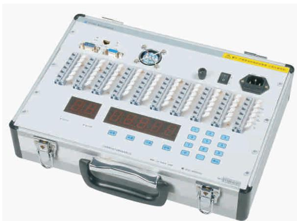
TST3822E-1(10测点)静态应变测试分析系统适用于学生实验以及小型工程，可单台手动控制，也可通过以太网与计算机连接控制，单台计算机可控制64台；各测点可分别组桥，方式为全桥、半桥、1/4桥(公用补偿片)，各测点参数单独设定，能同时测量应变、位移、压力、力等物理量；高清大面积数码管直接显示测量结果，人性化的按键操作，用户可以很方便的查看各测点的测量情况。采用德国进口WAGO压线端子，接线更加方便，程控切换桥路，以太网接口，数据传输更加稳定可靠。
